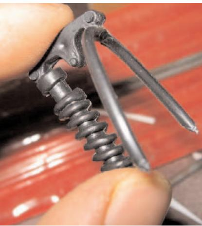
che ho costruito impiegando tubi di rame di diversa sezione, filo di ferro per la molla e il cavo che collega il gruppo al serbatoio per la regolazione. L'ammortizzatore è chiuso in basso da una ghiera realizzata in plasticard.
