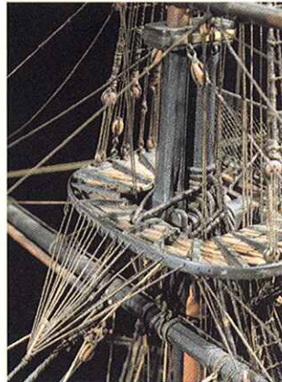
▲ Autre vue de la hune de misaine. L'on constate l'absence de poulie de drisse de basse vergue, celles-ci ne sont mises en place qu'en cas de besoin. Les drosses à l'anglaise sont systématiquement utilisées pour les basses vergues. L'araignée et les pompes d'étais seront abandonnées dans les années 1820.
