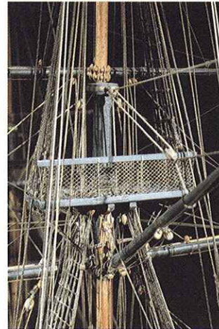
► Nous avons déjà examiné le gréement de la brigantine avec le modèle de la Crole . Nous retrouvons ici les mêmes éléments avec la drisse de corne dont la poulie double est frappée à l'œillet du chuquet. Au-dessus de celui-ci le racage à pommes et bigots de la vergue du perroquet de fougue. Sous la corne les poulies de cargue à deux et trois réas et entre les longis le palan de drisse de corne avec sa poulie simple frappée sur le croissant et sa poulie double sous la hune, de part et d'autre de celle-ci la poulie simple de balancine de gui.
