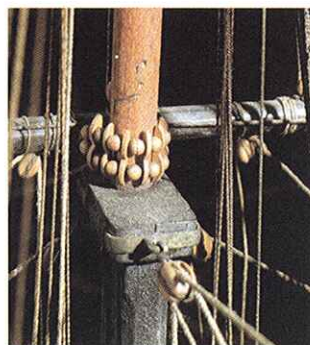
▲ Autre vue de la hune de misaine. L'on constate l'absence de poulie de drisse de basse vergue, celles-ci ne sont mises en place qu'en cas de besoin. Les drosses à l'anglaise sont systématiquement utilisées pour les basses vergues. L'araignée et les pompes d'étais seront abandonnées dans les années 1820.
