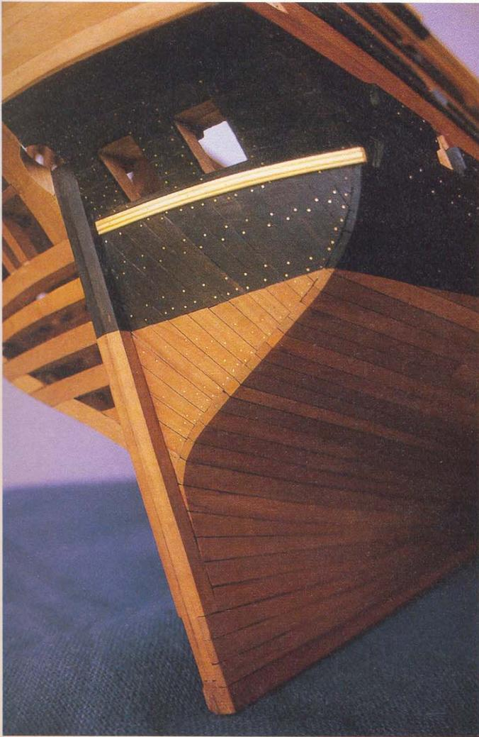
▲ Vista por la popa. Los forros de la carena recubren el extremo de las tracas del espejo. Obsérvese que sobre el codaste las tres tracas mas bajas no acaban en un alefriz, sino que se encastran en el codaste, y afloran en su cara posterior, que ha sido trabajada con nato afilado antes de poner el timón.
