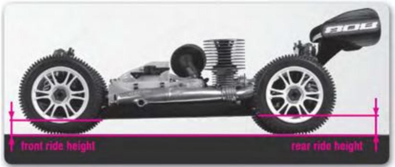
L'altezza da terra è l'altezza del telaio rispetto alla superficie su cui l'auto, completamente montata e pronta a partire, poggia.
