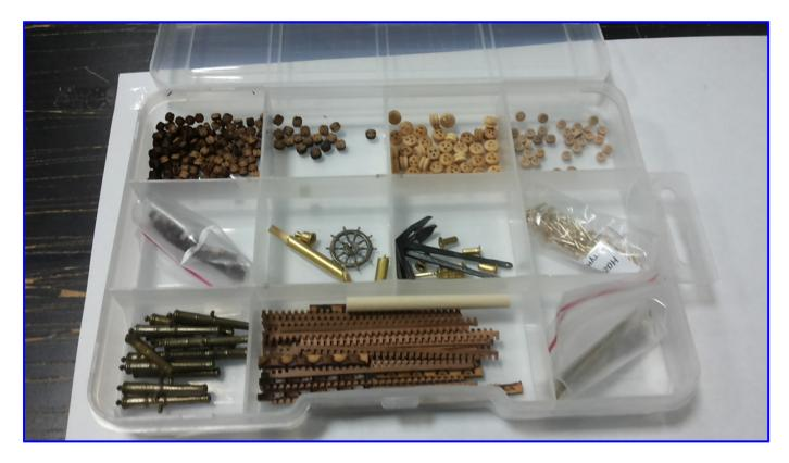
I particolari in metallo sono realizzati in ottone e lega, i carabottini in stecchette di facile montaggio.
