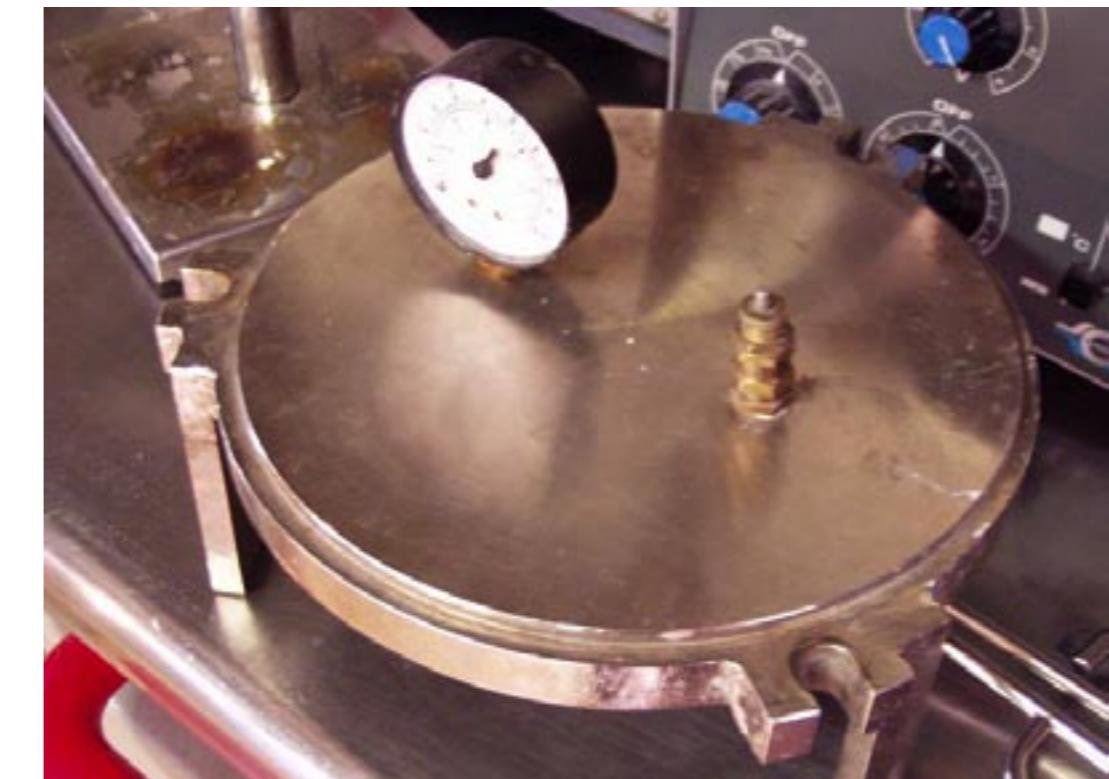
che quella in pressione. Scegliendo di estrarre aria dallo stampo, basterà un coperchio con una buona guarnizione; una volta stretto il coperchio, se la guarnizione funziona a mestiere, per effetto del vuoto che si forma all'interno, il coperchio verrà schiacciato contro il recipiente aumentando la tenuta.
