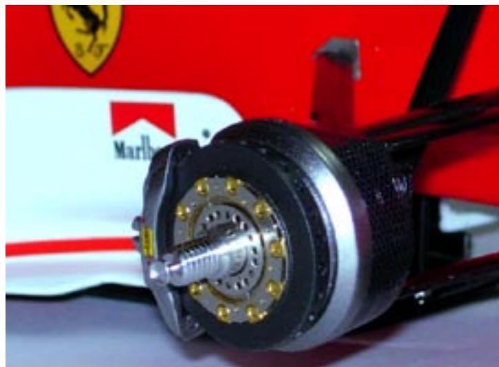
in alluminio e dadi serraggio del kit sms (molto laborioso il lavoro di modifica della struttura dei pezzi in plastica dei freni del kit revell per far inserire correttamente i perni)
