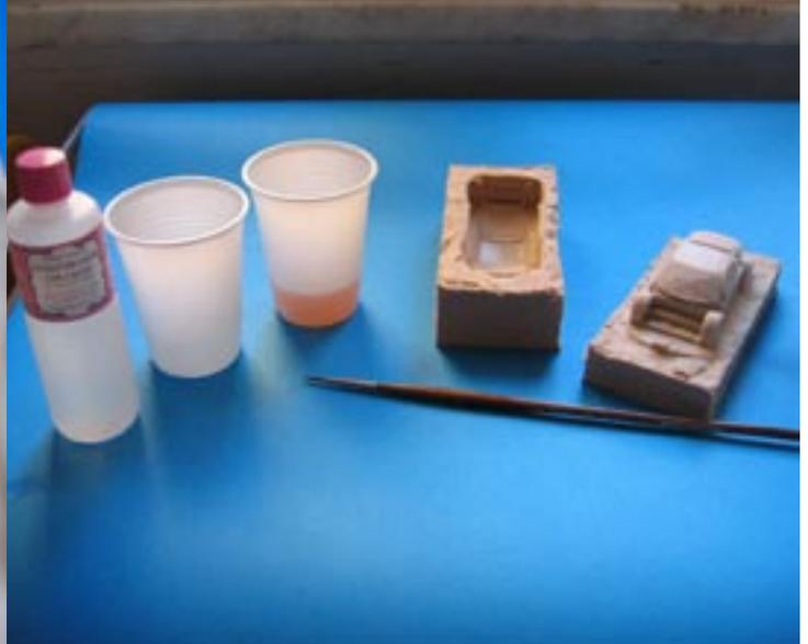
le, le bolle d'aria si sono create lo stesso. Questo costituirà un problema quando colerò la resina nello stampo. Le bolle d'aria si trasformeranno in spazi che la resina andrà a riempire erroneamente.
