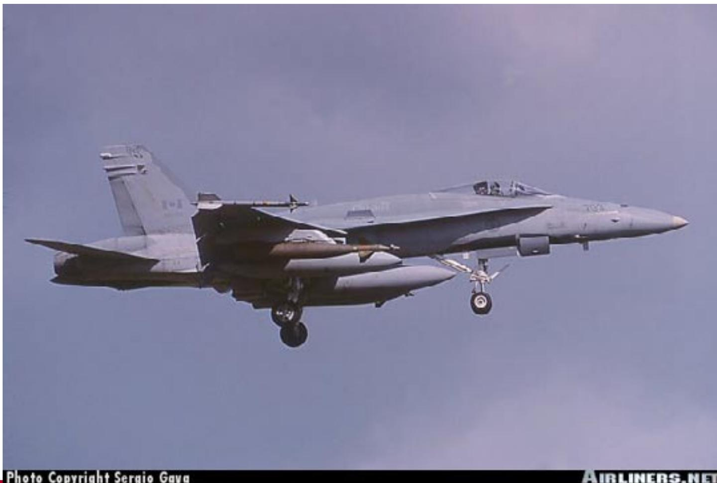
Il velivolo canadese differisce dagli altri per l'introduzione di un faro di ricerca sul lato sinistro della fusoliera, tale faro è stato in seguito adottato anche sui velivoli svizzeri e finlandesi.
