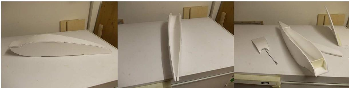
Terminata la fusoliera prendiamo le misure per un pezzo di compensato da 5mm che verrà posto all'interno della naca/testa che utilizzeremo come supporto motore.
